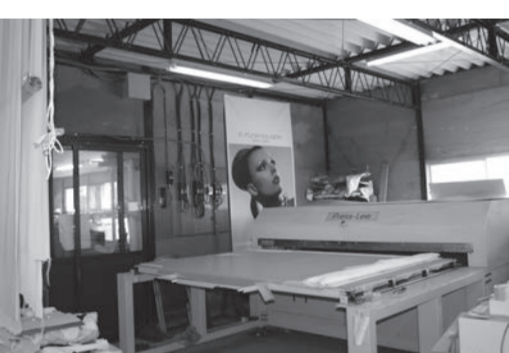
大柳工芸の工場内。高性能の特殊印刷機が所狭しと並び、のほりや巨大ポスターなどを印刷する大型昇華転写プリントが可能な専門業者は少なく、同社の有する技術は高く評価されている。
