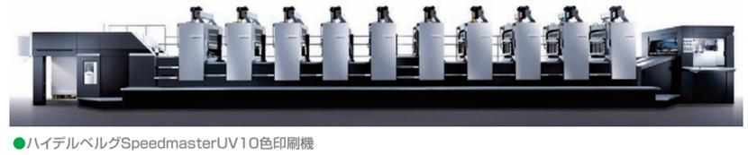
●ハイデルベルグSpeedmasterUV10色印刷機
