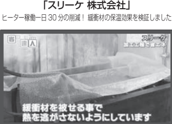
「スリーケ 株式会社」ヒーター稼働一日30分の削減! 暖房材の保管効果を検証しました
