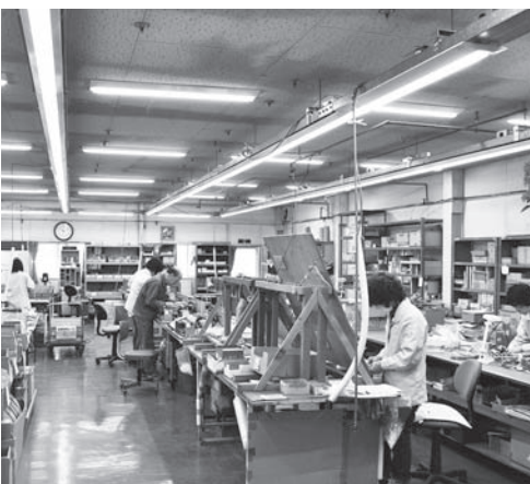
最新のLED照明を導入した工場内。明るさのばらつきもなくなった。
