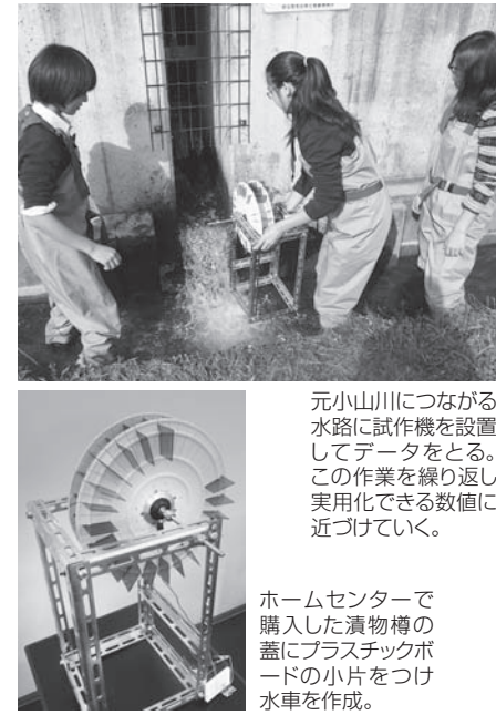
水車式の発電機。スクリーンタイプな試験設備を経て、一昨年から水車式の発電機を取り組んでいる。
