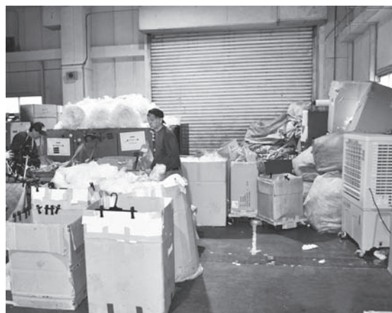
写真右側の冷風機からの風で体感温度は3~5℃下げられる。
